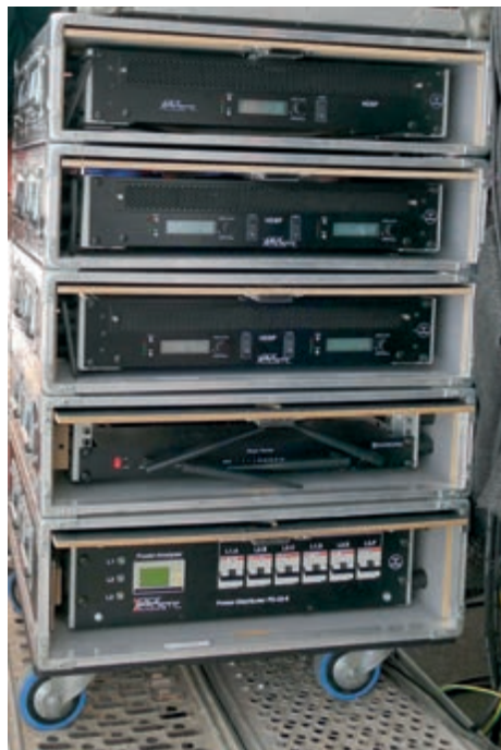
Zwei HDSP-6A Endstufen treiben sechs Ikarry-8 und acht Paveosub-118 an
