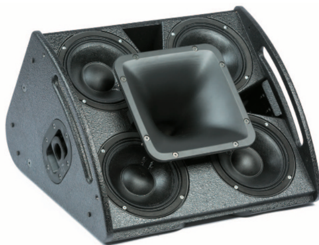
CXN-16 ohne Frontgitter mit den vier 8"-Treibern und dem großen, mittig angeordneten 60 \times 40 Hochtonhorn. In der Monitorposition, wie hier auf Bild, sind es 40 \times 60 , um einen schmalen Korridor auf der Bühne für den jeweiligen Akteur präzise beschallen zu können
